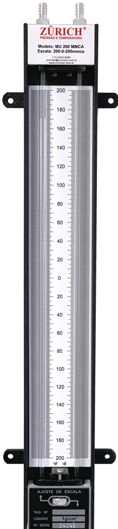
Fig. 2-1 (Manômetro com os dois lados abertos. O líquido está na mesma altura)
