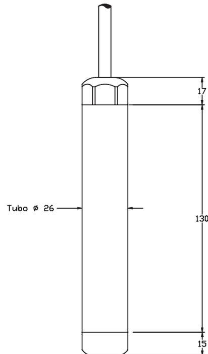
O modelo SONDA.1 é um transmissor de nível que pode operar submerso até 300 M.C.A., seja para medir mares, profundidade de rios, lagos, caixas d' água, poços, esgotos, etc.
