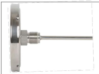
O registro da temperatura é obtido através do sensor termométrico (bimetal). O bimetal térmico é composto de dois metais com diferentes coeficientes de dilatação, laminados juntamente e possui forma helicoidal. O bimetal, durante a variação de temperatura, transforma a energia térmica em mecânica, girando um eixo conectado ao ponteiro, indicando a temperatura na escala do mostrador.
