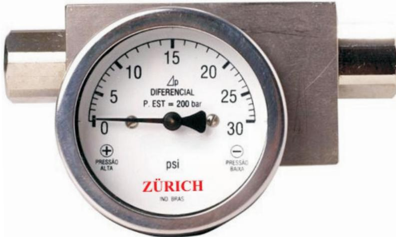
Invólucro construído em alumínio com sensor magnético, caixa e capa em aço inoxidável e visor em vidro para aplicações em processos gasosos.
